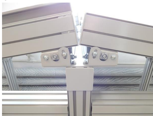
rys. 29. Montaż płyty głowic dwustronnych
